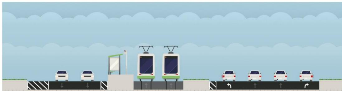
Profil sur tronçon périurbain : emprise nécessaire minimale de 45m avec la station et les voies de virage à gauche opposée.
