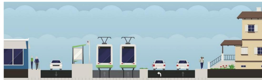
Profil en station : emprise nécessaire minimale de 25,9m avec la station et la voie de virage à gauche opposée.
