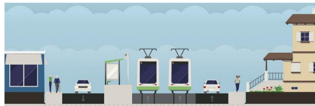
Profil en station : emprise nécessaire minimale de 21,6m
