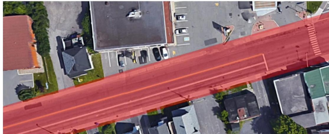
L'exemple ci-dessous, illustre l'emprise nécessaire pour implanter un SRB / Tramway en site central, ainsi qu'une station à la hauteur de la rue Millar. On peut ainsi observer que la perte des marges de recul est bien moindre et que les stationnements en façade des bâtiments pourraient être en partie maintenus.
