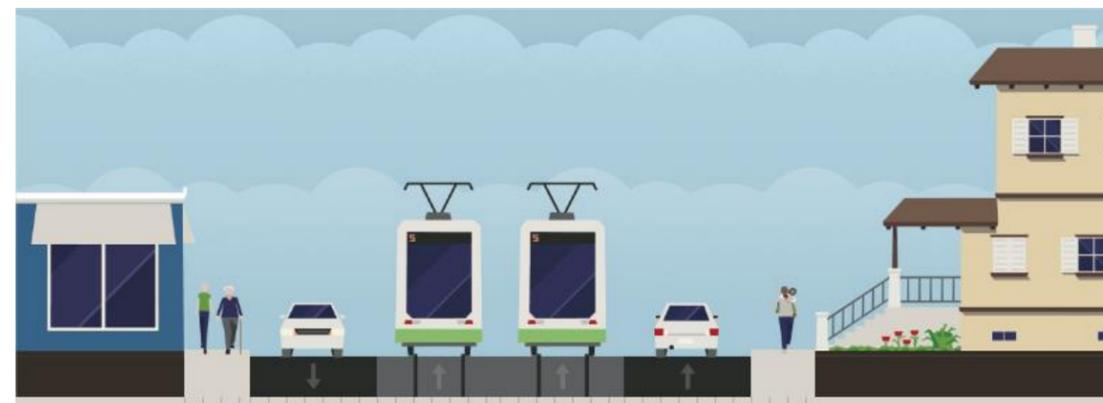
Profil en section courante : emprise nécessaire minimale de 17,4m
