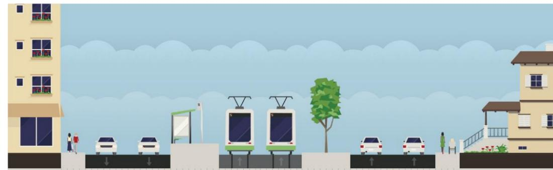
Profil sur tronçon urbain : emprise nécessaire souhaitable de 32,8m avec des terres-pleins de 4m permettant d'y implanter une station, une voie de virage, des arbres, des supports de LAC, de l'éclairage ou des feux de circulation.
