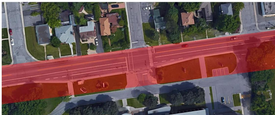
L'exemple ci-dessous, illustre l'emprise nécessaire pour implanter un SRB / Tramway en site central. On peut ainsi observer la perte des marges de recul et du stationnement en façade des bâtiments. Avec les emprises nécessaires pour effectuer les travaux, il est fort probable que l'un ou l'autre des bâtiments illustrés doive être détruit.
