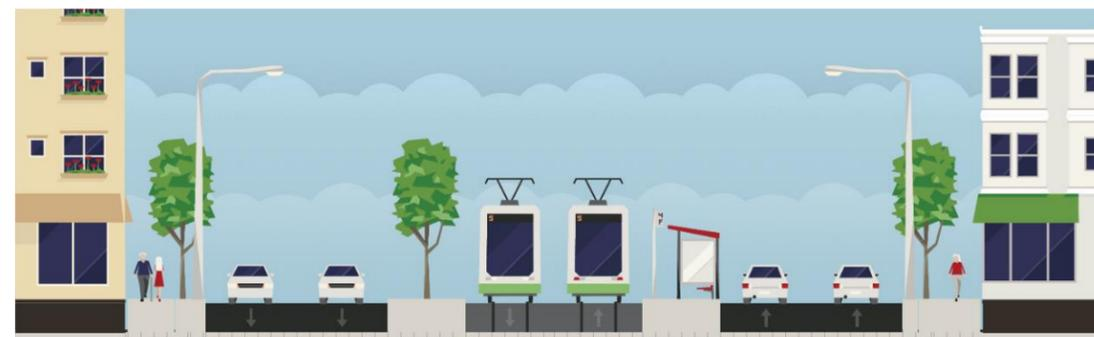
La réduction de la circulation à une voie (de 4 à 5 mètres, bordure à bordure) par direction ne permet pas de sensiblement diminuer ce besoin puisqu'il passe ainsi à quelques 31m selon les mêmes hypothèses de haute qualité d'aménagement ou à 28m en optant pour des aménagements minimalistes.
