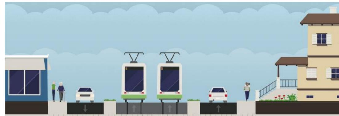
Profil en section courante : emprise nécessaire minimale de 19,8m avec des terres-pleins de 1,2m permettant d'y implanter des supports de LAC, de l'éclairage ou des feux de circulation
