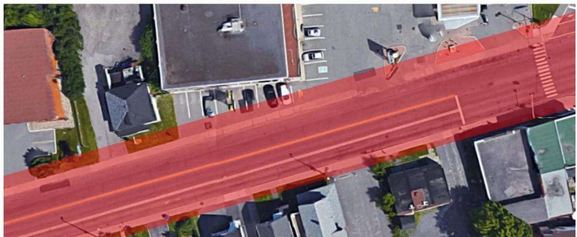
L'exemple ci-dessous, illustre l'emprise nécessaire pour implanter un SRB / Tramway en site central, ainsi qu'une station à la hauteur de la rue Millar. On peut ainsi observer la perte des marges de recul et du stationnement en façade des bâtiments. Il semblerait par contre que les bâtiments ne seraient pas touchés.
