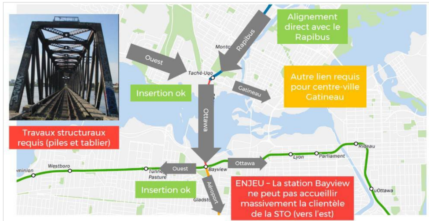
Figure 2-5 Constats sur le pont Prince-de-Galles et arrimage à la station Bayview
